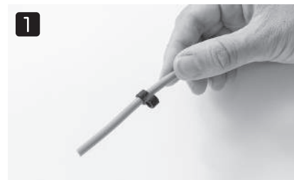
1 ロープに結束ゴムを片側のみはめます。
